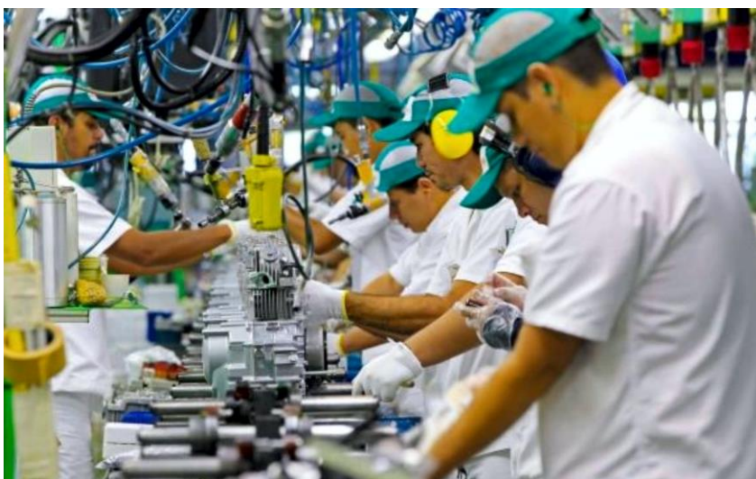
Figura 1 – Exemplo de processo produtivo com ausência de espaço (linha montagem do motor com uma quantidade enorme de equipamentos, cabos e mangueiras)
