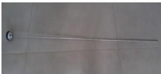
**Figura 7** – Geofone eletrônico
