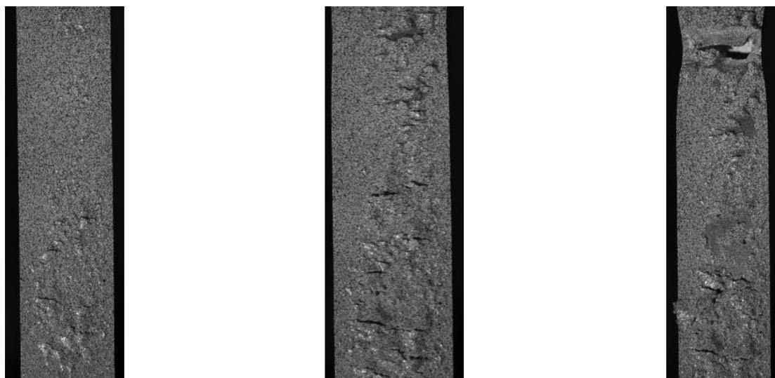
Figura 14 - Exemplos de descamação na pintura dos corpos de prova de tração
