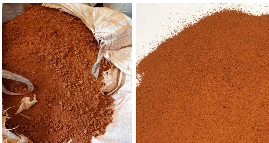
Figura 2 - (a) resíduo de lama vermelha bruta e (b) resíduo beneficiado
