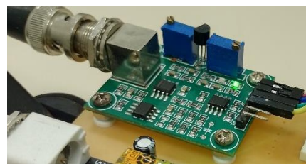
Figura 2 – Sensor de pH. A – Sonda; B - Placa de condicionamento.
