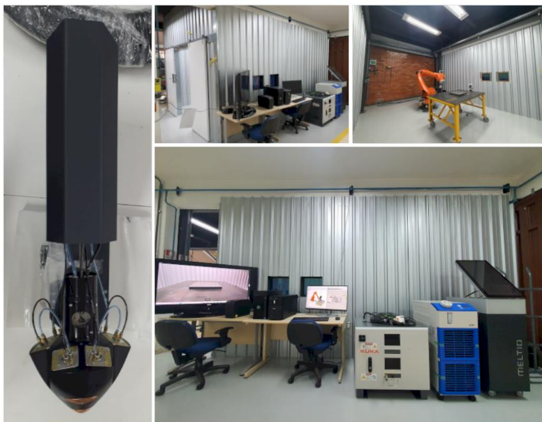
Figura 1 – Célula de manufatura aditiva robótica LMD-Wire : Kuka KR70 R2100.
